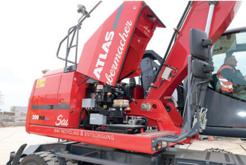
Blick auf die zentrale Schmieranlage des Atlas 200MH. Zwei getrennte Behälter dienen der Versorgung des Drehkranzes bzw. der restlichen Komponenten.
