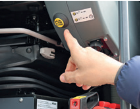
Nach der Auto-Abschaltung der Elektrik kann der Fahrer komfortabel mit Knopfdruck den Batterie Hauptschalter in der Kabine aktivieren.
